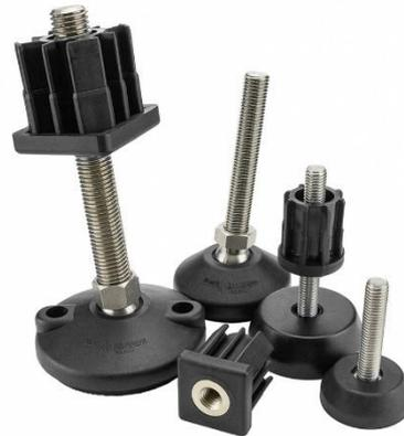
Unsere bewährten Gelenkfüße aus verstärktem Polyamid, mit großer Kugelpendelung zum Ausgleich hoher Winkelfehler. Ab 80 mm Teller Ø optional mit seitlichen Befestigungsbohrungen zum Verschrauben im Boden. Für Standard- und Sondermaschinen im unteren und mittleren Gewichtsbereich. Komplementiert wird das Angebot durch unsere Gewindeeinsätze aus glasfaserverstärktem Polyamid, welche das Einschrauben der Nivellierelemente in quadratische oder runde Rohre ermöglichen.
