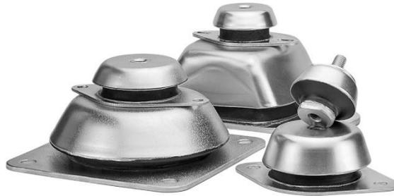
Geeignet für die Lagerung einer Vielzahl verschiedener Maschinen. Spezielle Merkmale sind die geringe Bauhöhe und die durch Vulkanisierung miteinander verbundenen Ober- und Unterteile. In der Ausführung mit Abreiß-Sicherung ist auch die Wand- und Deckenmontage realisierbar. Eine Nivellierung ist möglich durch die Version mit Sackloch-Gewindeinsatz oder entsprechend gekonterte Stellschrauben.
