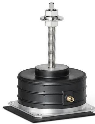
Das FLN Luftfederelement besteht aus einem mit Stahlringen verstärkten Elastomer-Druckbehälter, mit angeschraubter Aluminium- bzw. Stahlbodenplatte. Es sind 8 Größen lieferbar, für Punktlasten von 15 daN bis 10000 daN. Bevorzugte Anwendung für niederfrequente Aktiv- oder Passivlagerungen bei Meßmaschinen, Meßtischen, Fundamenten, Stanzautomaten, Nibbelmaschinen, Kompressoren sowie Lüftungs- und Kühlaggregaten.
