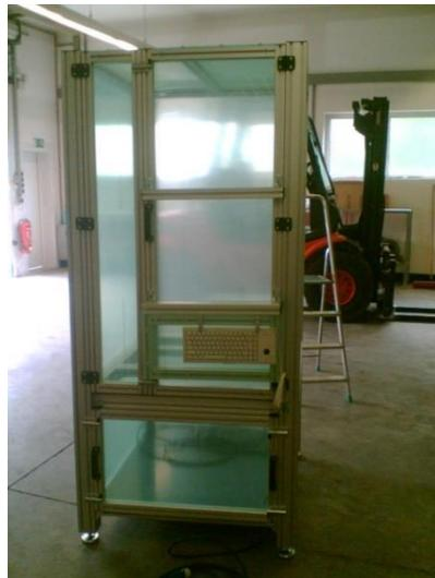
**bwz<sup>®</sup> - Profiltechnik** Untergestell für Optische Meßmaschinen mit Schreibtisanbausatz
