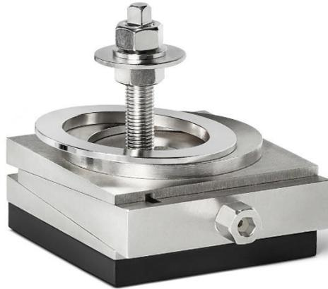
Geeignet für die Aufstellung, Nivellierung und schwingungsgedämpfte Lagerung von schweren Werkzeugmaschinen, Kunststoffspritzmaschinen, Pressen, Stanzen oder auch für Passivisolierung bei Meßmaschinen. Lieferbar in den Varianten freistehend, anschraubbar und durchschraubbar, optional mit Kalotte zum Winkelausgleich oder ohne Elastomerbelag zur reinen Maschinenausrichtung und Nivellierung.
