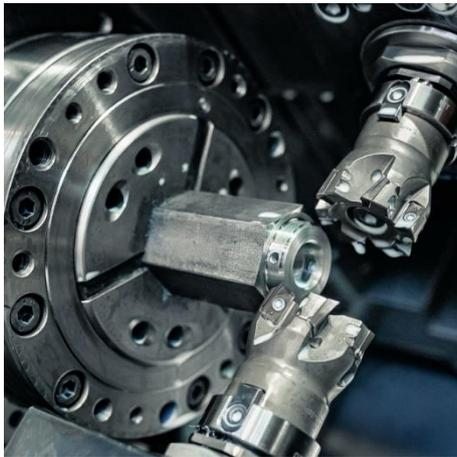
Auf Doppelspindel-Drehmaschine mit 3 Revolvern und angetriebenen Werkzeugen
