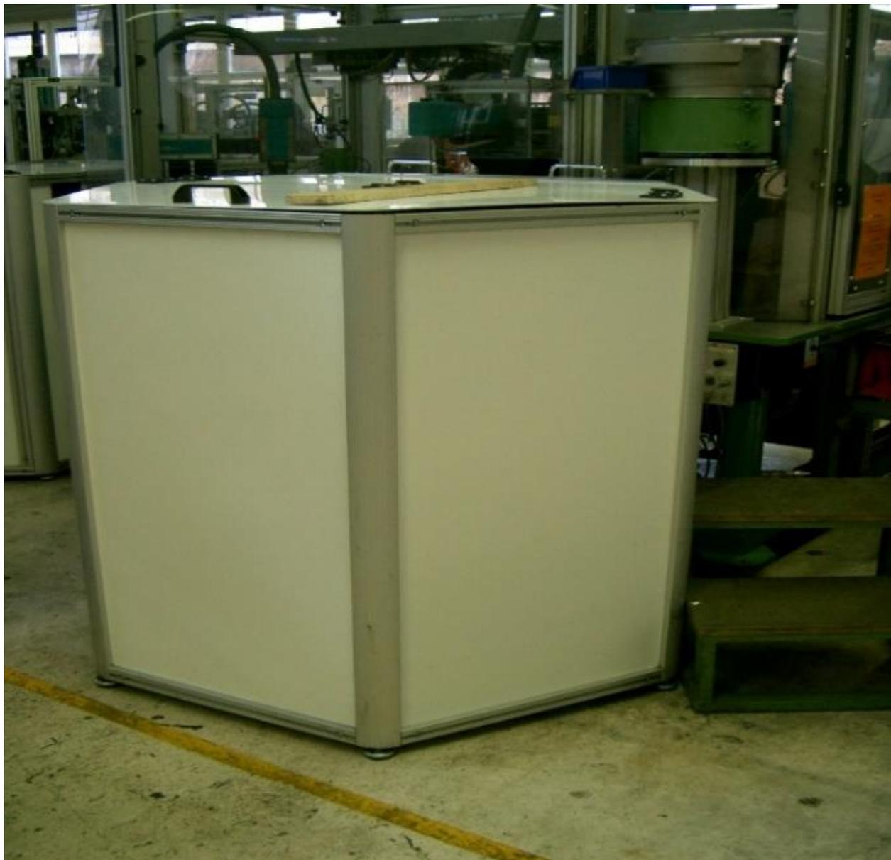
**bwz® - Profiltechnik** Profil P88 80 x 80 5L ( 8 – Nut E )
