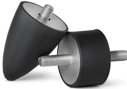
Universell in der Konstruktion einsetzbare Rundlager für Motoren, Pumpen, Kompressoren, Ventilatoren sowie überall dort, wo Einheiten schwingungstechnisch voneinander entkoppelt werden müssen. Geeignet für Druck- und Schubbeanspruchung, in den Härtegraden 43, 57 und 68 Shore A. Werkstoff: NR (Naturkautschuk), Stahlteile verzinkt. Sonderelemente in NBR, Edelstahl, abweichenden Härtegraden und/oder in elektrisch leitfähig gerne auf Anfrage.
