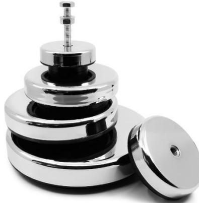
Die Produktserie NMS zeichnet sich durch Stabilität und exakte Nivellierbarkeit aus, und ermöglicht eine verankerungsfreie Maschinenaufstellung, insbesondere für Pressen, Stanzen und vergleichbare Maschinen. Das ein vulkanisierte Elastomer mit Gleitschutzprofilierung verringert die Neigung zum Wandern der Maschine bei hohen Horizontalkräften. Durch die galvanische Oberflächenveredelung ist ein zuverlässiger Korrosionsschutz geboten. Für Punktbelastungen von 300 daN bis 4000daN.
