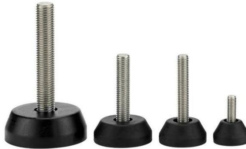
Unsere Festen Stützfüße bestehen aus Thermoplast-Elastomer mit fest eingespritztem Gewinde aus Edelstahl. Gedacht für die einfache Aufstellung und Nivellierung von Geräten und Maschinen jeder Art, bei der es nicht vorrangig um Schwingungsdämpfung oder Schwingungsisolierung geht. Mit Durchmessern von Ø 30 mm bis Ø 70 mm, und Punktbelastungen von 150 daN bis 550 daN. Optional mit Elastomerbestückung.
