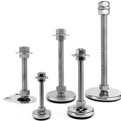
Universell einsetzbare Maschinenfüße mit Tellerdurchmessern von 50 mm bis 130 mm, modular kombinierbar mit verschiedenen Gewindelängen und Gewindestärken. In verzinktem Stahl oder in Edelstahl, pendelnd oder mit feststehendem Gewindebolzen. Ideal für Maschinen und Geräte im unteren bis mittleren Gewichtsbereich.
