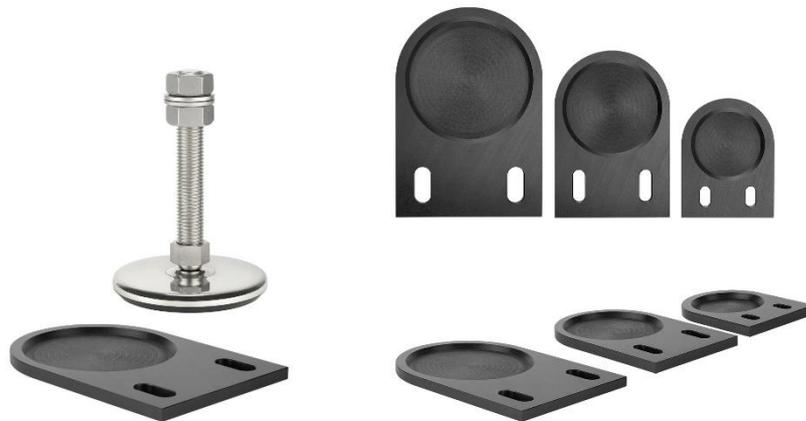
Diese aus hochfestem Kunststoff präzise gefrästen Befestigungselemente mit Langlöchern für Bodendübel eignen sich zur Maschinenpositionierung bei hohen Horizontalkräften und Wanderungsneigung.
