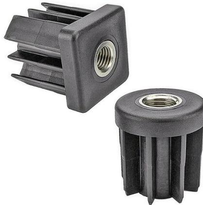
Quadratische und runde Gewindeeinsätze ermöglichen beispielsweise das Einschrauben unserer Gelenkfüße, Schwingungsdämpfer, Nivellierelemente und Stellschrauben in das offene Ende von Rund- oder Quadratrohren.
